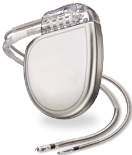
Двухкамерный ИКД с электродами
